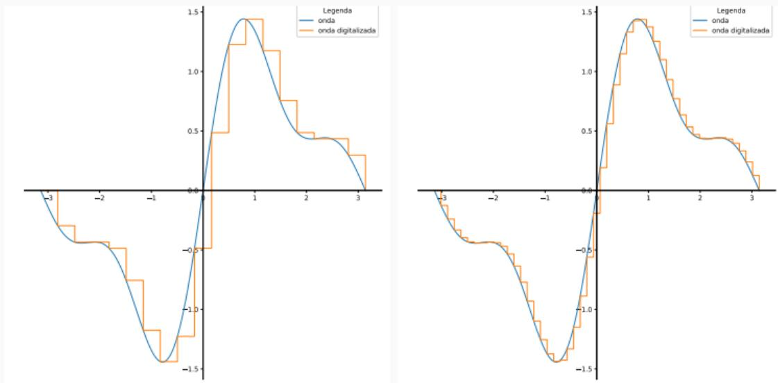
À esquerda a frequência de amostragem para a geração do dado digitalizado é menor, gerando um ajuste pior.
